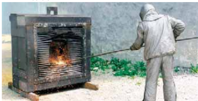
Versuch mit Sauerstoffflanze an Objektschutzgitter
