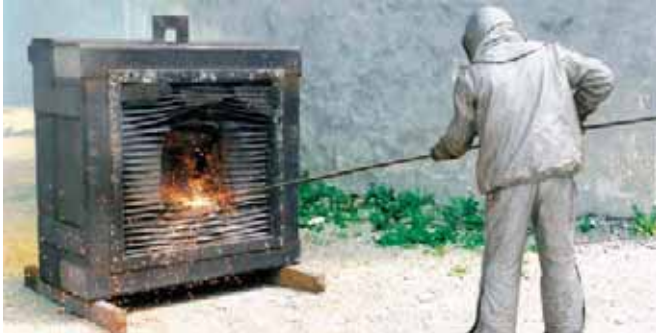
Versuch mit Sauerstoffflanze an Objektschutzgitter
